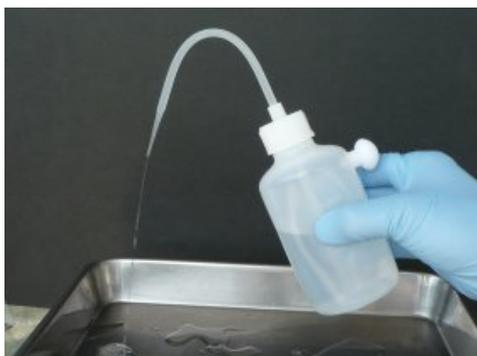
エンジン部品の脱脂・洗浄には、ピンチャを取り付けた洗浄瓶にアセトン等を入れてご使用いただくと便利です。ピンチャは、殆どの溶剤にてご使用頂けますが洗浄用ラッカーシンナーには適しません。
